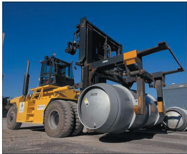
Figura 1: Cilindro Tipo 48Y com capacidade para doze toneladas de UF 6 . Fonte: EUA (1999).
