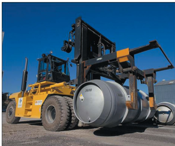
Figura 1: Cilindro Tipo 48Y com capacidade para doze toneladas de \text{UF}_6 . Fonte: EUA (1999).
