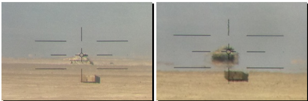
Figura 2 – As fotos acima representam um alvo visado pelo EMES15 da VBCCC Leopard 2 A4 a uma distância de 1650m. À esquerda, o alvo sendo visualizado às 09:00 horas e à direita o mesmo alvo sendo visualizado às 15:00 horas.
