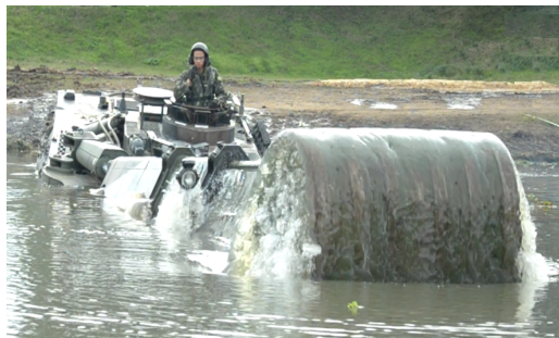
Figura 05: VBC Eng trabalhando na melhoria das margens para lançamento de pontes e portadas flutuantes.
