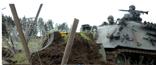
Figura 03: VBC Eng realizando a abertura de passagem num campo de obstáculos.
