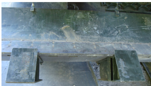
Figura 6: Adaptador grudado na lâmina de apoio.
