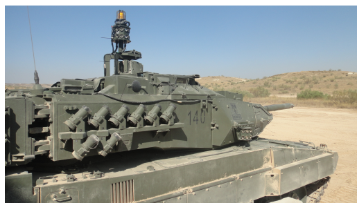
Figura 7: Módulos de Referência do DSET Tecnobit instalado na VBC CC Leo 2E (Exército Espanhol).
