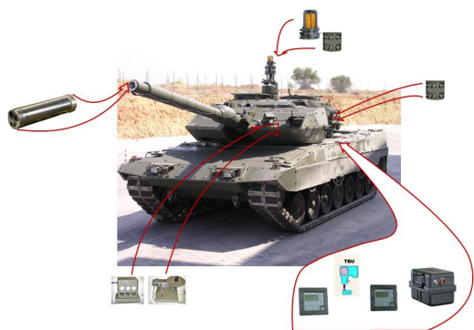
Figura 2: Sensores e dispositivos do DSET Tecnobit espanhol na VBCCC Leo 2E. Fonte: TECNObIT
