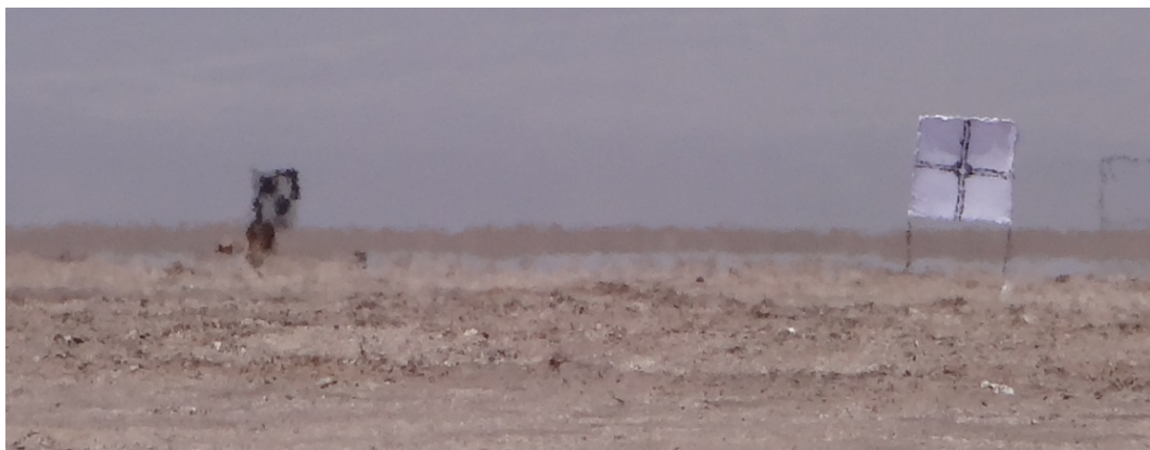
Figura 3 – Alvos de colimação e correção em zero em período do dia favorável à ocorrência de refração
