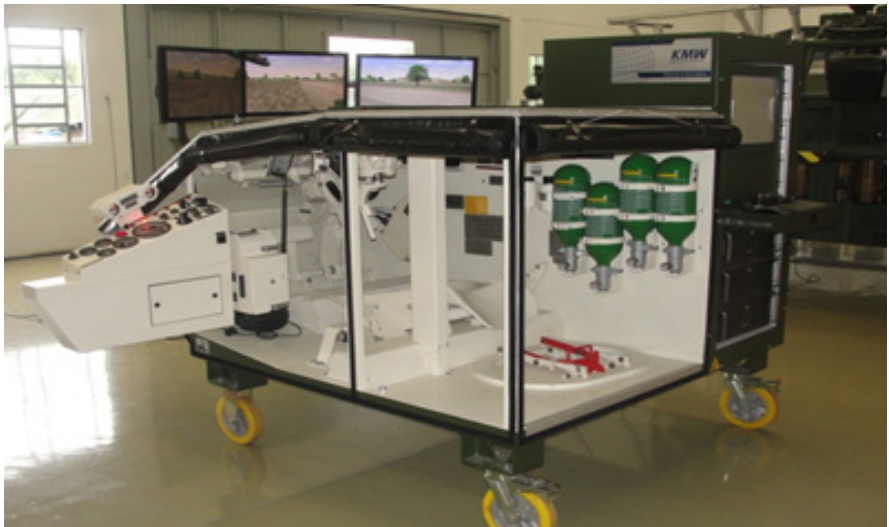
Fig 6: Simulador de Procedimento de Motorista –SPM
