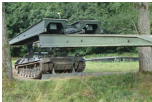
Figura 1: VBE L Pnt lançando a ponte.
