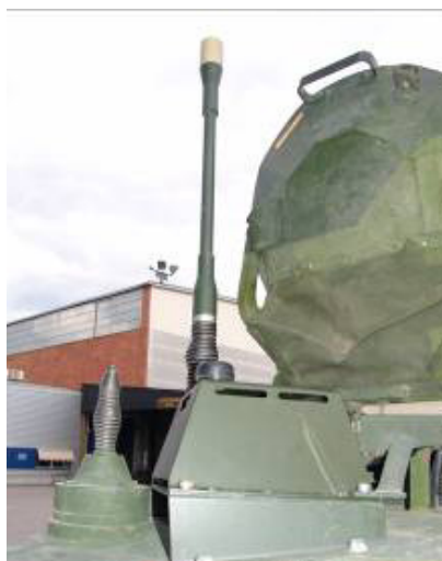
Figura 4 – o receptor (à esquerda) e o emissor (à direita) do sistema de identificação amigo ou inimigo (IFF) que está sendo testado pelo exército sueco.
