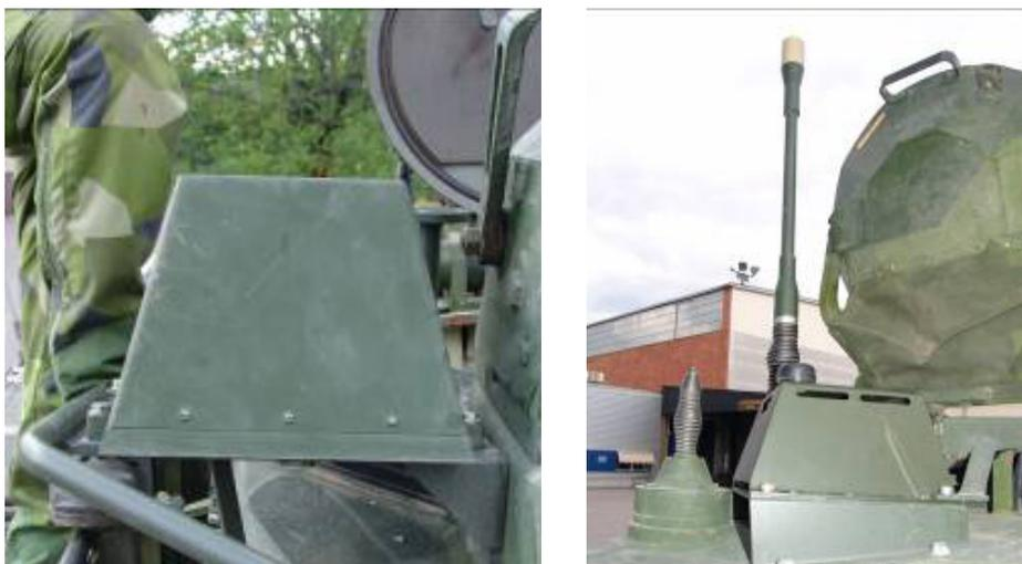
Figura 4 – o receptor (à esquerda) e o emissor (à direita) do sistema de identificação amigo ou inimigo (IFF) que está sendo testado pelo exército sueco.
