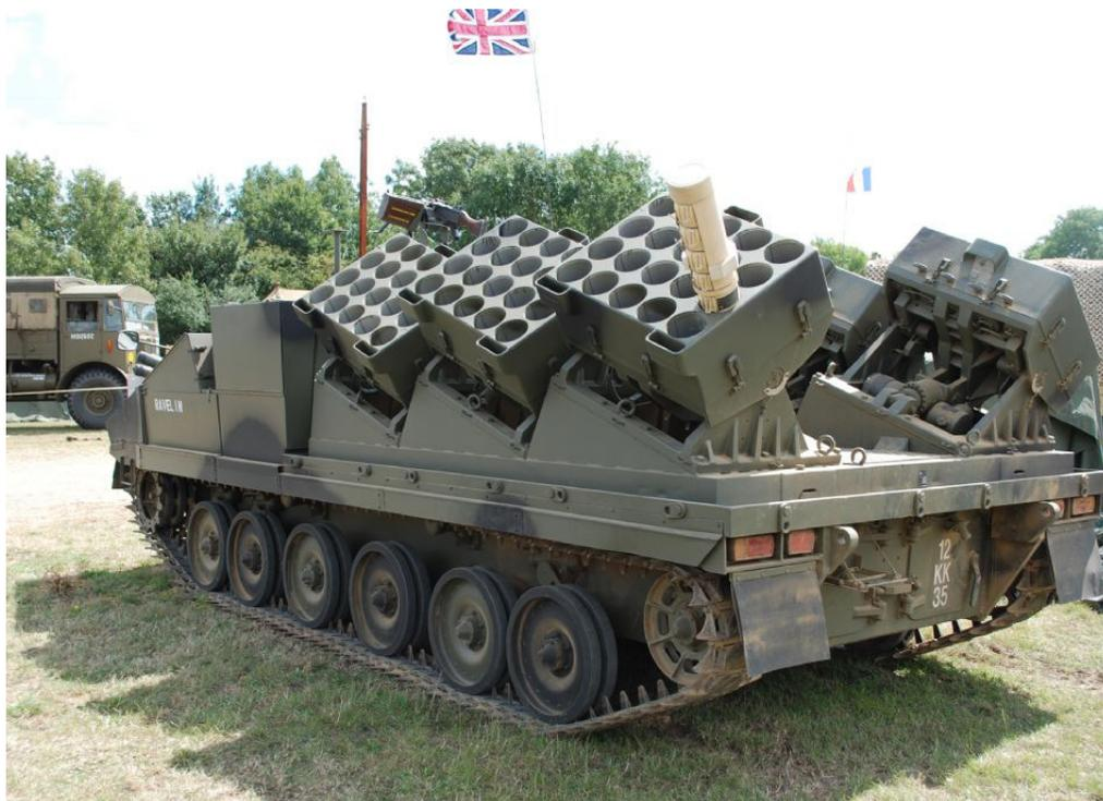
Figura 03 - Sistema lançador de minas MINOTAUR
