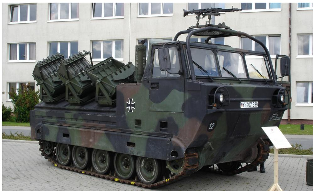
Figura 02 – Sistema lançador de minas SKORPION
