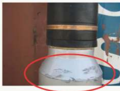
M1 Abrams danificado após explosão de munição; à direita, deterioração do invólucro propelente
