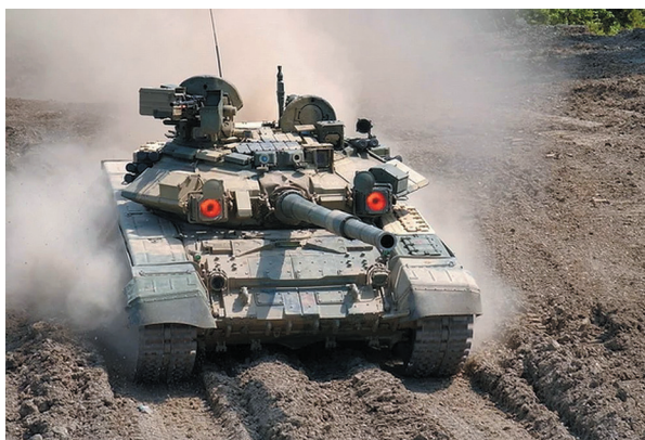
Figura 2: T-90 equipado com o APS Soft Kill Shtora-1 . Os dois “olhos” vermelhos são os bloqueadores eletro-ópticos
