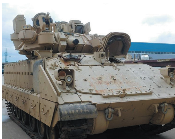
Figura 5: M2 Bradley equipado com o APS Iron Fist Fonte: Breaking Defense
