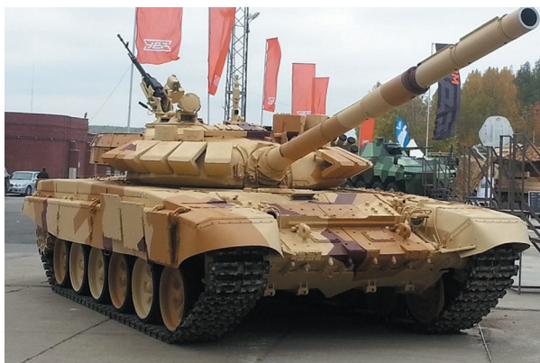
Figura 3: T-72B3 equipado com o APS Arena-E Fonte: Techsob
