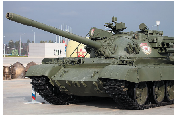
Figura 1: T-55AD equipado com o APS Drozd Fonte: Vitaly V. Kuzmin
