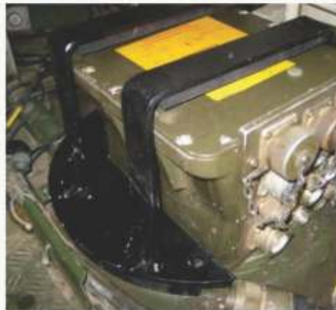
À esquerda, um ataque de IED em janeiro de 2011, estimado em 40 kg de explosivo caseiro (HME); não houve feridos na guarnição e o CC voltou a operar após 4 dias. À direita, braçadeiras na caixa de contato contínuo.
