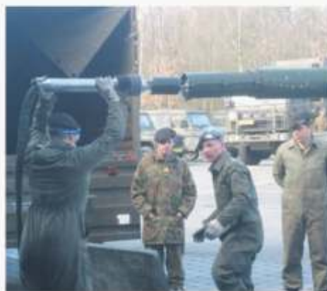
Em depósito, os Leopard 2A6 somente têm recebido manutenção de armazenamento; à esquerda, o emprego de desumidificador, e à direita, limpador automático do tubo.
