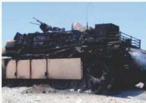
M1 Abrams danificado após explosão de munição; à direita, deterioração do invólucro propelente
