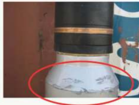
M1 Abrams danificado após explosão de munição; à direita, deterioração do invólucro propelente
