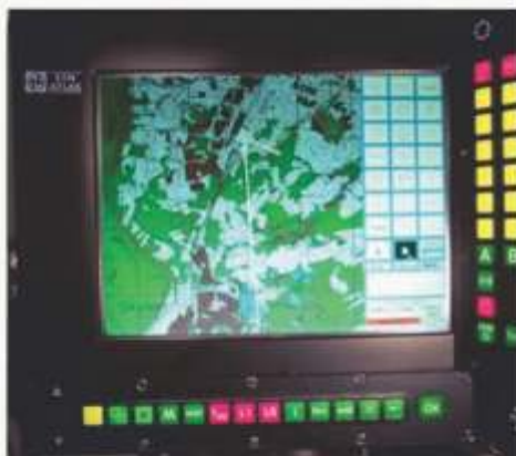
O sistema de gerenciamento de campo de batalha TCCS instalado nos carros suecos.
