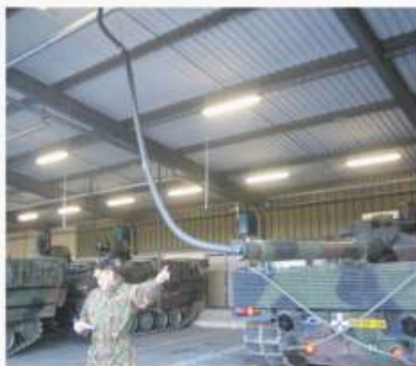
Em depósito, os Leopard 2A6 somente têm recebido manutenção de armazenamento; à esquerda, o emprego de desumidificador, e à direita, limpador automático do tubo.
