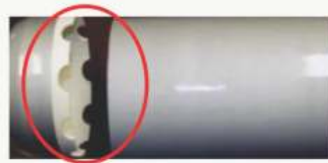
À esquerda, o antigo ponto de junção do invólucro propelente; à direita, o novo ponto, que situa-se em local de menor atrito durante o manuseio da munição
