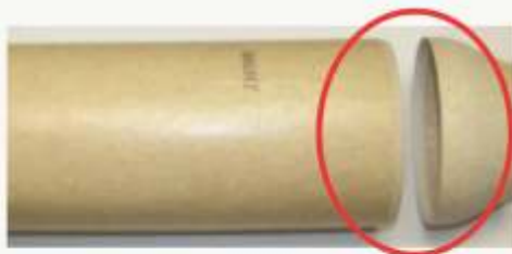
À esquerda, o antigo ponto de junção do invólucro propelente; à direita, o novo ponto, que situa-se em local de menor atrito durante o manuseio da munição
