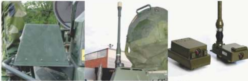
À esquerda e no centro, o sistema IFF instalado no CV-90 sueco. À direita, o sistema AMIGOS, de fabricação espanhola.
