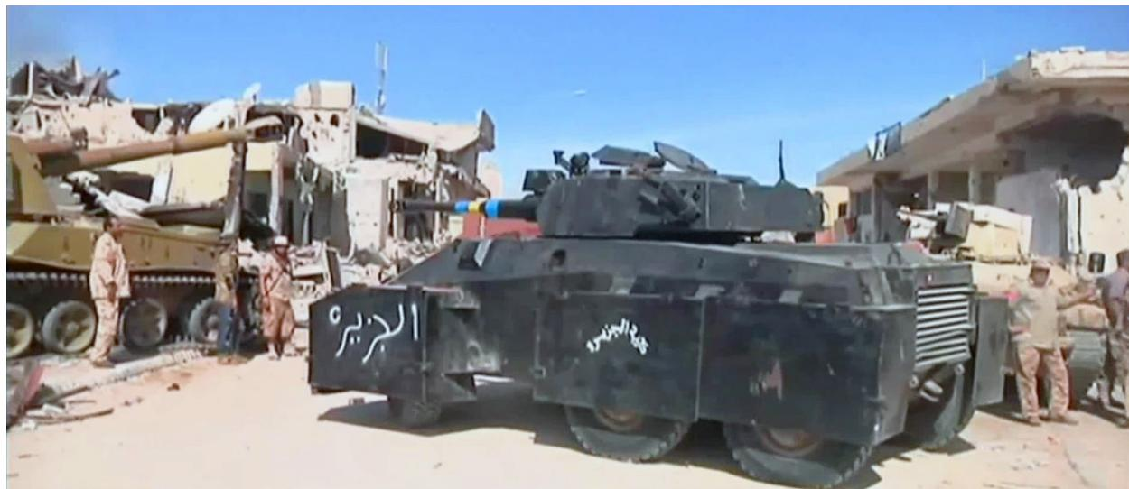
Figura 5: EE-9 Cascavel M3-S2 (Líbio) todo pintado de preto e com saias de proteção lateral, frontal e traseira, confeccionadas em chapas de aço, as quais podem ser abertas para acesso aos pneus, operando na cidade de Sirte em 22 de novembro de 2016. O interessante é que sua mobilidade não foi prejudicada. Nas laterais pintados em branco: Batalhão Al-Jazira.
