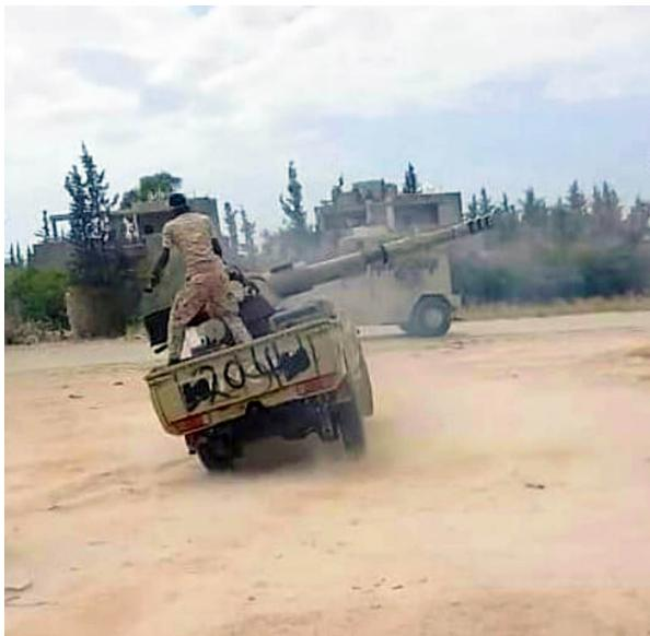
Figura 6: Líbia 16 de maio de 2019. *Technical* Toyota Land Cruiser armada com canhão Engesa EC-90 realizando disparo próximo a Trípoli. Notar o tiro lateral e a estabilidade do veículo.
