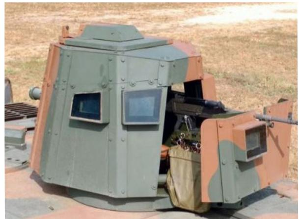
Figura 07: Torre PLATT instalada em Vtr Bld.
