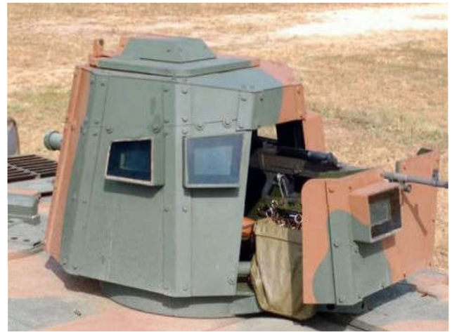
Figura 07: Torre PLATT instalada em Vtr Bld. Fonte: CCOMSEx.
