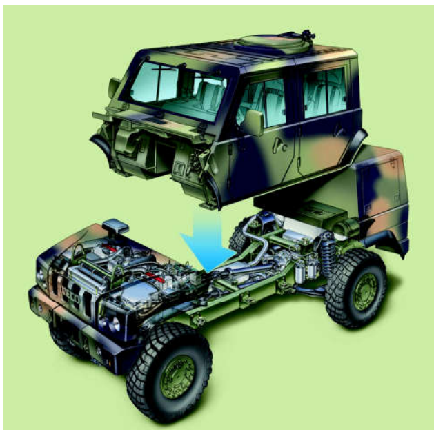
Figura 3: Célula de sobrevivência da VBMT - LSR. Fonte: www.forte.jor.br
