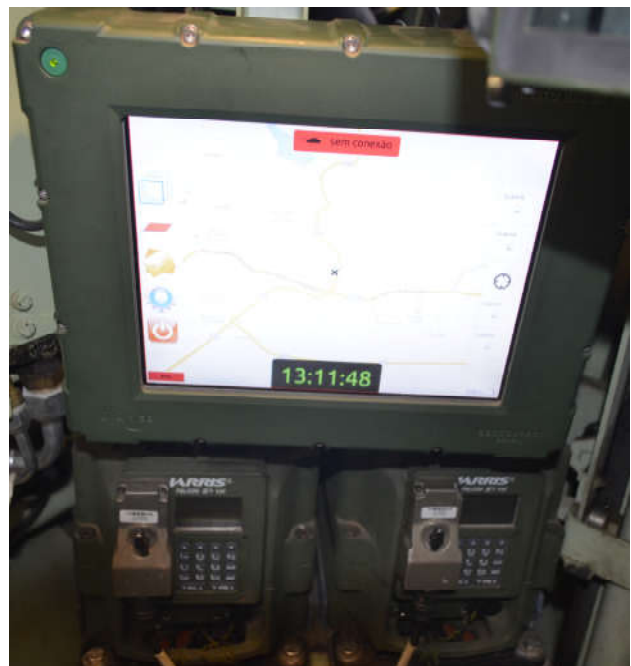
Figura 11: Computador Tático Militar instalado na VBTP Guarani. Fonte: www.cibld.eb.mil.br e editada pelo autor.
