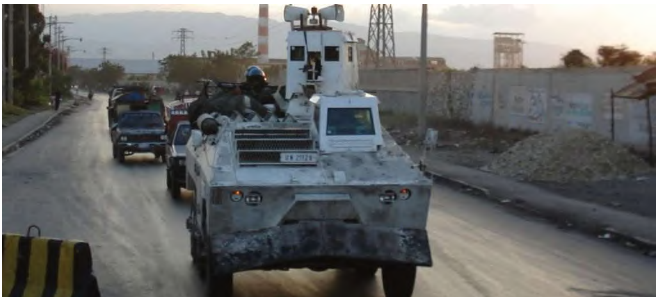
Figura 3: Urutu com cabines de proteção balística para o motorista e atirador e lâmina frontal.
