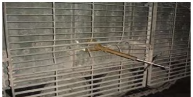
Figura 9: Blindagem do tipo gaiola atingida por RPG.
