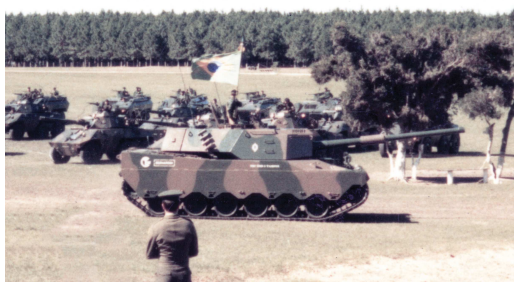
Figura 5: Tamoyo III, com canhão L7 A3 de 105 mm, com a torre redesenhada e construída em aço e material composto, na Festa da Cavalaria, no Rio Grande do Sul, em 10 de Maio de 1987.
