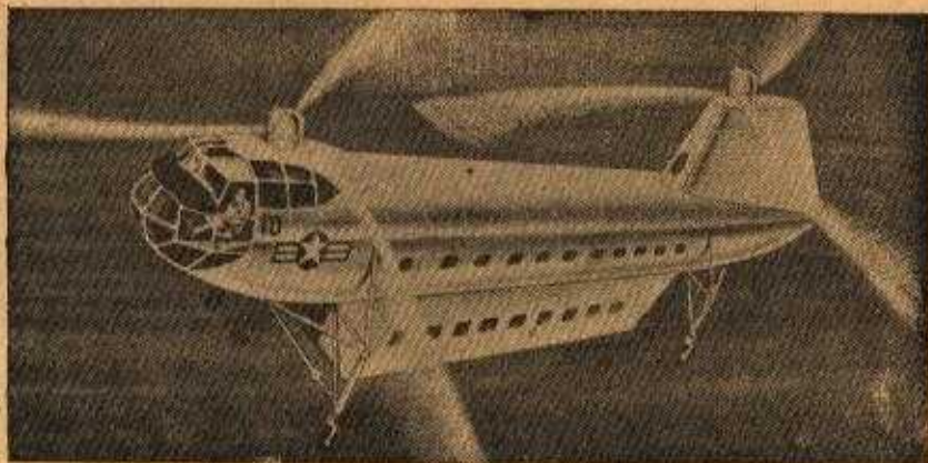
Fig. 2 — O tipo que se vê acima, de um Peasecki, acha-se em fase experimental e já foi apelidado de "Caminhão voador". Se as experiências forem coroadas de êxito, a sua fuselagem destacável poderá ser de grande utilidade
