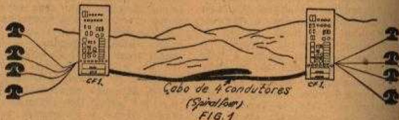
O aparelho de telefonia por ondas portadoras CF-1 permite estabelecer 4 comunicações telefônicas por um mesmo cabo
