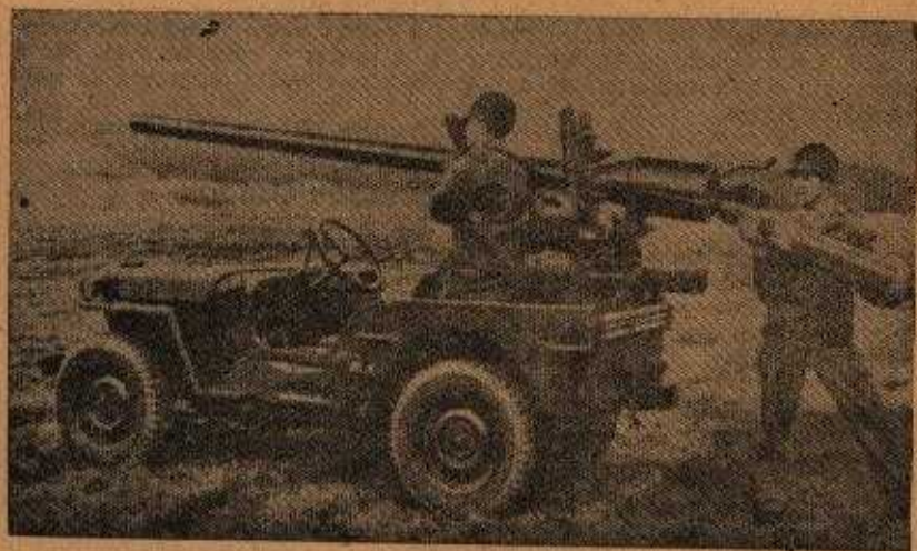
Canhão de 105 mm, sem recuo anticarro, montado sobre "jeep". Os serventes são apenas 3: um apontador e 2 municiadores. Alcance: 8 Km. Vel.: 10 disparos por minuto. Inconveniente: muito vulnerável.
