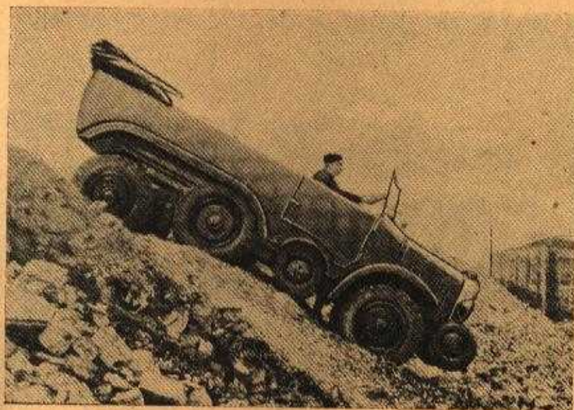
Note-se a diferença na posição das rodas motoras.
