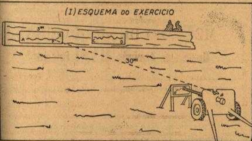
Fig. 41 — Execução: O apontador, visando com a luneta, procura acompanhar a linha sinuosa desenhada para alvo, manejando os volantes de direção e elevação. O simples confronto entre o registro dos movimentos do canhão e o alvo mostra a precisão e firmeza de seu trabalho.
