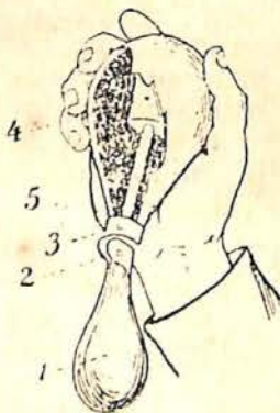
Fig. 5 — Granada de tempo, modelo limão (franceza). 1) Percutor. 2) Capuz. O granadeiro, antes de jogar-a, tem de destruir o capuz, batendo-o contra um corpo duro.
