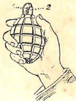
Fig. 6 — Granada de tempo Brillant (franceza). 1) Colher de alumínio. 2) Charneira. 3) Percutor. 4) Detonador. 5) Pasta de fulminato.
