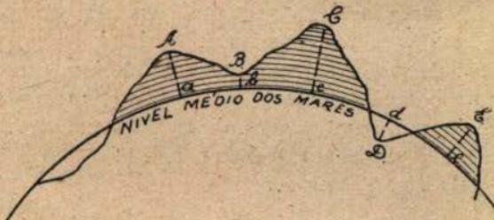
Sobre a superficie elipsoidal, então, cada ponto A daquela primeira superficie, definir-se-á por sua projeção a, cujas coordenadas geograficas são as mesmas que o fixam sobre o elipsoide de revolução, e por uma distancia Aa, dada pelo valor de sua projetante e chamada **cota** do ponto A.
