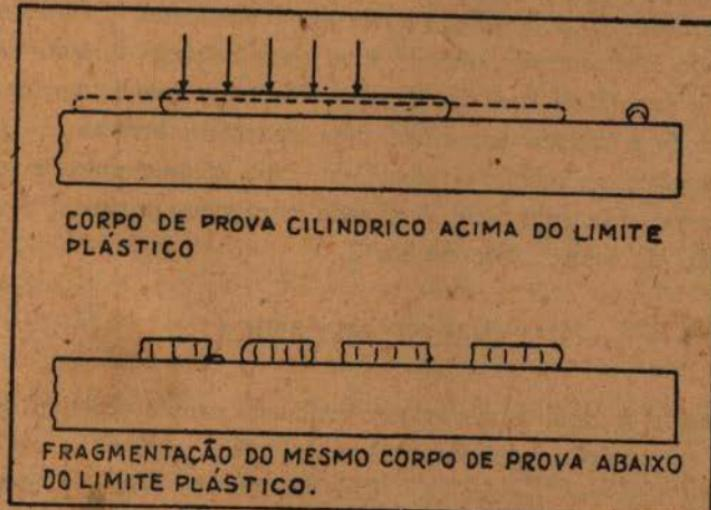
Fig. 2 — Ensaio de limite plástico
