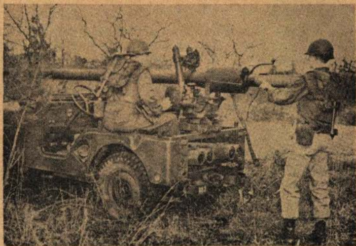
FIGURA 3 — "BAT", 106mm, montado sobre jipe
