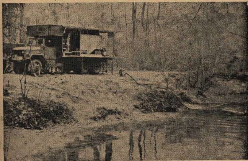
Sem auxílio das mãos, este aparelho esterilizador de águas que é montado sobre um caminhão, pode livrar a água de quaisquer contaminações, inclusive de radioatividade. Pode esterilizar 3 mil galões por hora
