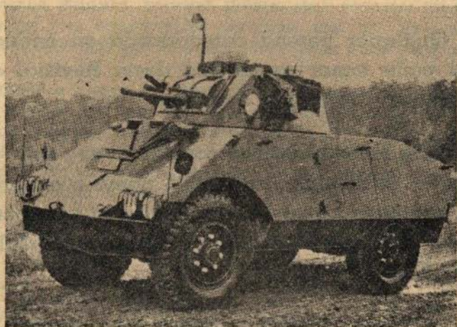
Bild 2: Ausf. B mit 60-mm-Mörser
