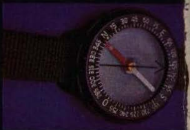
BÚSSOLA PORTÁTIL DE CAMPANHA AM03089 Cápsula com agulha magnetizada, marcas fluorescentes para leituras noturnas
