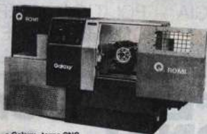
• Galaxy - torno CNC com torre de 7 estações, motor CC de 14 cv
