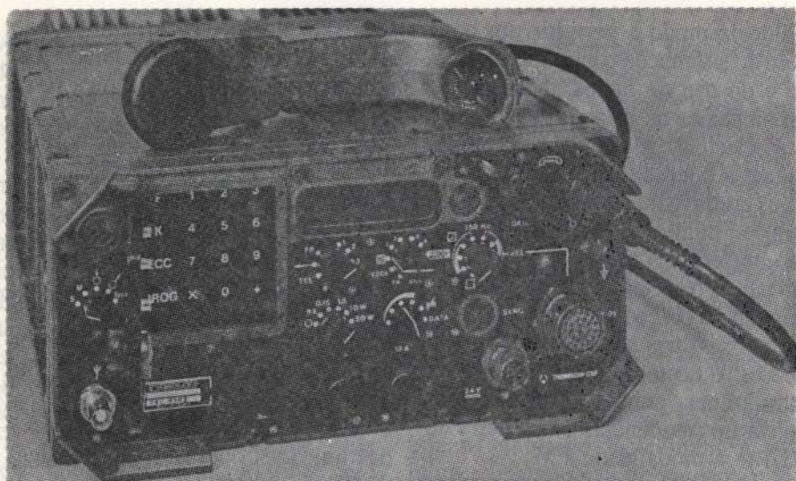
FIGURA 6 — Conjunto-rádio TRC 950. Projetado para operar em ambiente de Guerra Eletrônica, tecnologia Thomson — CSF, France. (Cortesia da Thomson — CSF, Eletrônica Profissional Ltda. — representantes.)
