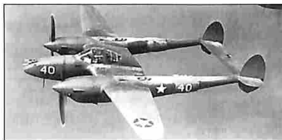
Lockheed P-38F Lightning da USAAF. O caça bimotor orgânico do 339º Fighter Squadron era armado com dois canhões 20mm e quatro metralhadoras .50
