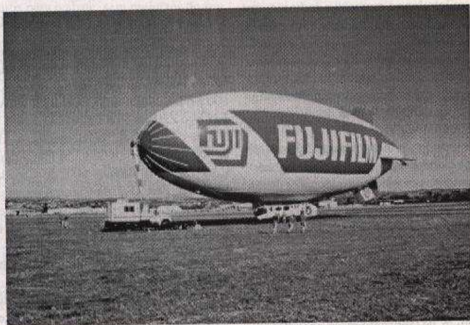
FOTO 4: Equipagem de solo apoiando a decolagem do SKYSHIP-600
