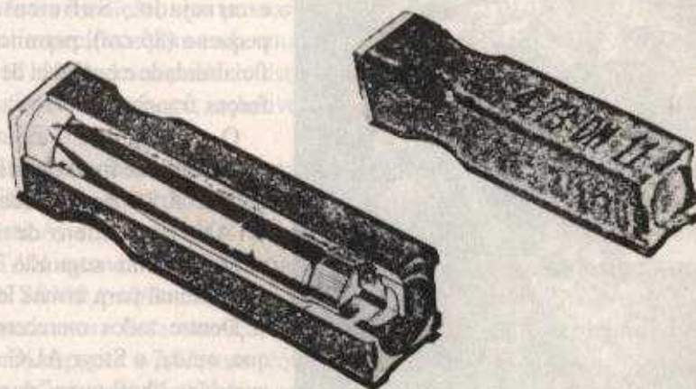
FIGURA 03: O cartucho 4,73mm (DM11), sem estojo (caseless) do Fz G11. O desenho em corte representa a configuração interna desse revolucionário cartucho. O booster garante a total eficiência do propelente.
