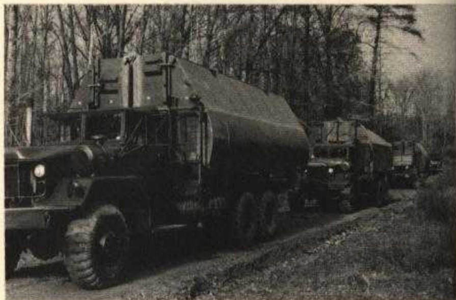
Viatura transporta Ponte RIBBON
