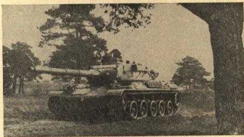
Carro francês AMX 30, o mais móvel dos carros europeus e americanos contemporâneos. Seu armamento principal é o canhão de 105 mm, que dispara munição estabilizada de carga oca.
