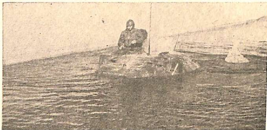
Fig. 1 — O Carro AMX 30 (francês), de 30 t, pode transpor imerso cursos de água com o máximo de 4 metros
