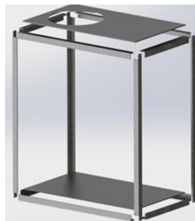
Fig. 1 - Representação esquemática do gabinete de suporte em vista explodida.
