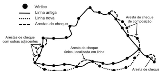
Fig. 1 – As quatro situações básicas que uma aresta de cheque aparece em uma rede de nivelamento.
