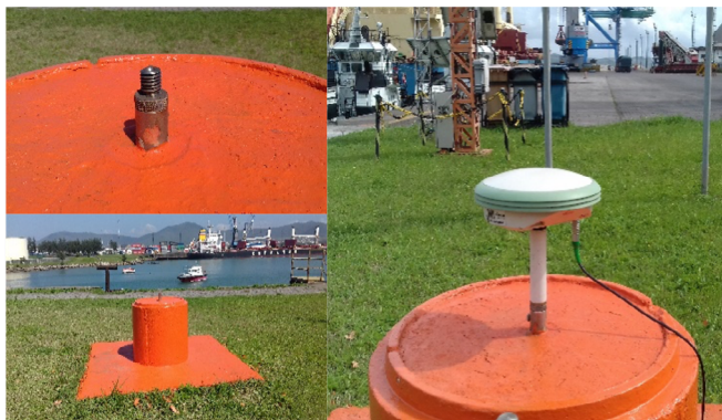
Fig. 3 – DCF implantado em um marco geodésico.
