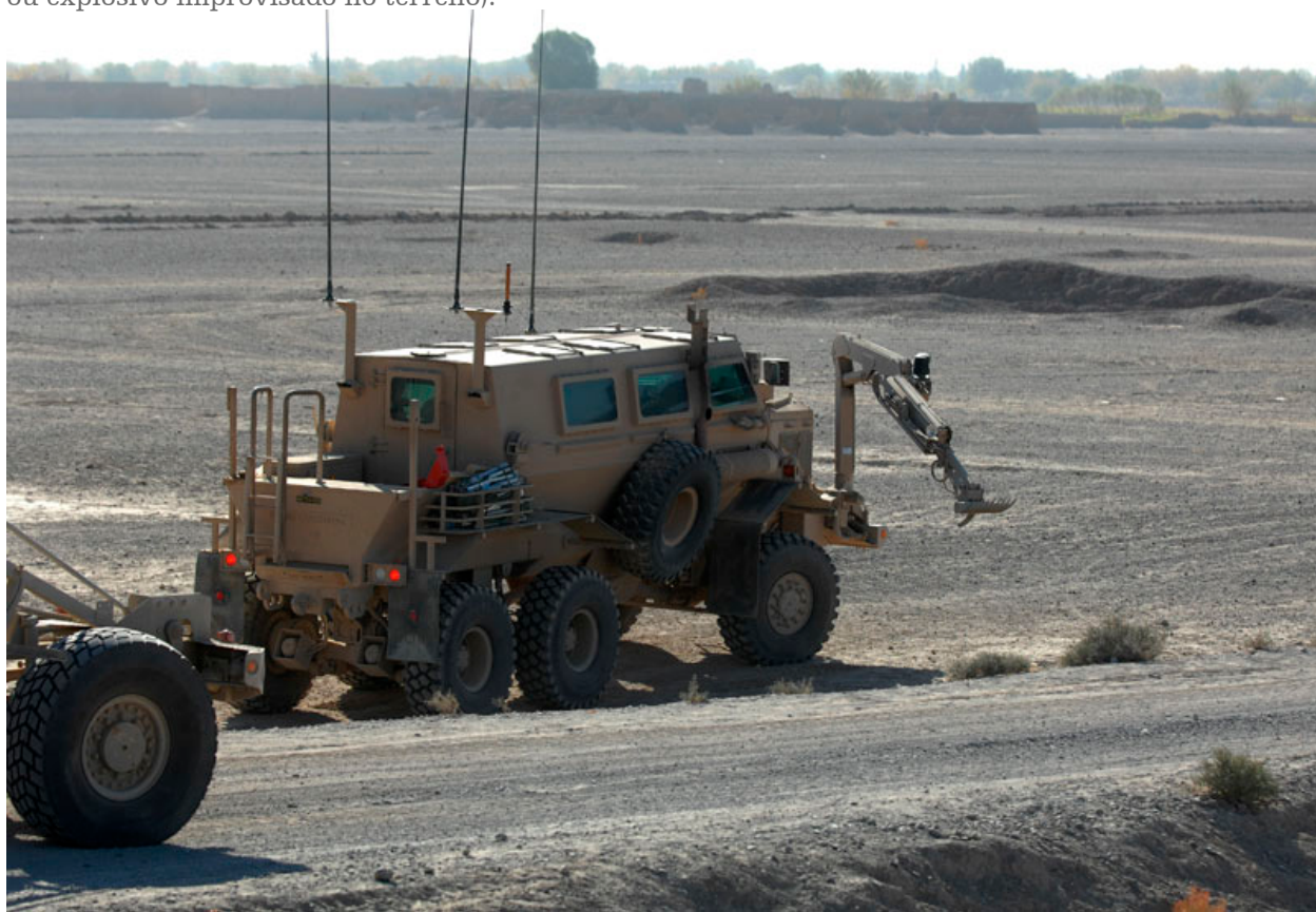
Fig 5– Forças Mec Bld (Viatura Buffalo com seu braço extensivo capaz de verificar a presença de mina ou explosivo improvisado no terreno).
