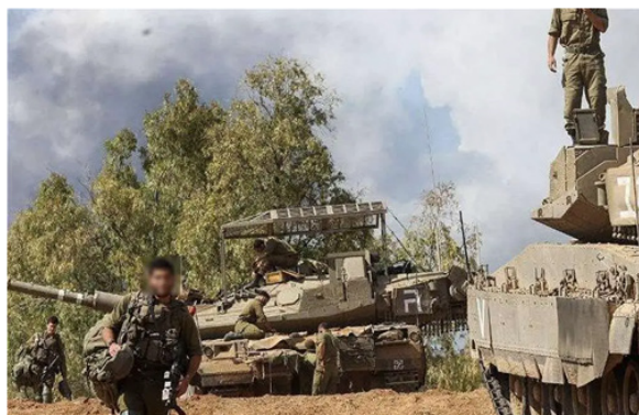
Fig 2 - Gaiola de defesa anti-SARP em CC Merkava durante a ocupação de Gaza
