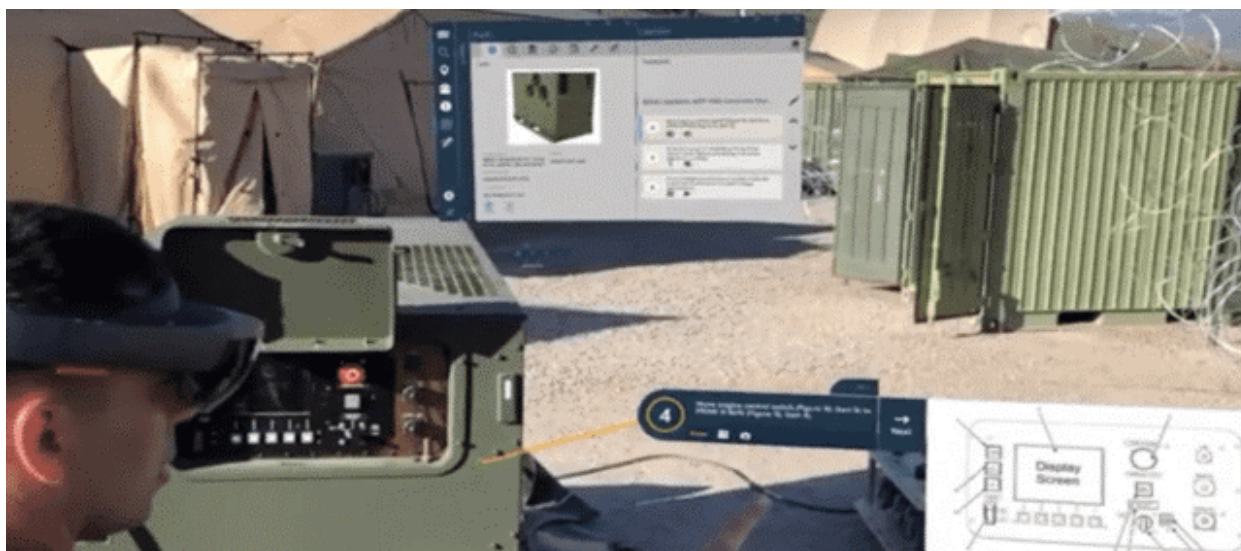
Fig 1 - Utilização de Big Data conjugada com Realidade Aumentada na telemanutenção
