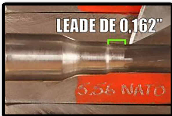
Comparativo do leade nas munições calibre .223 Remington e 5,56x45mm NATO
