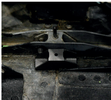
Fig 8 - Peça impressa pela FAEUA em comparação com a instalada na aeronave
