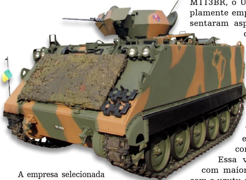
A empresa selecionada para realizar a modernização foi a inglesa *Bae Systems Enterprise* e as principais modificações/melhorias realizadas foram no conjunto de força (com mudança do motor e da caixa de transmissão), no sistema de arrefecimento, no de lubrificação, no de suspensão e trens de rolamento, e no elétrico.
