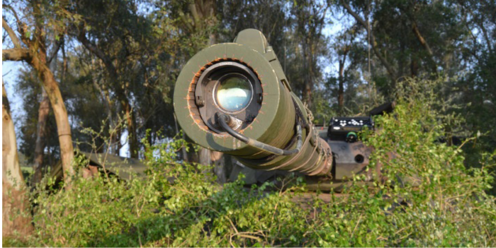
Figura 5 - Tubo Leopard 1A2 equipado com emissor laser
