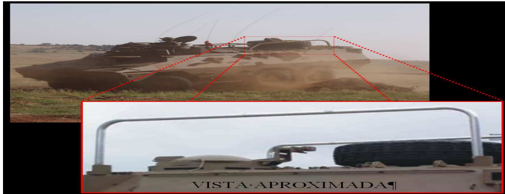
Figura 04: Utilização da antena tipo loop na parte superior de uma viatura.
