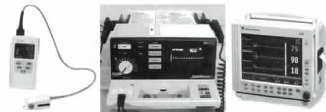
Figura 2. Exemplos de EEM: a. oxímetro de pulso; b. desfibrilador; c. monitor de sinais vitais.
