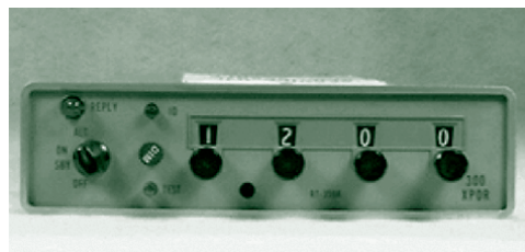
Figura 3: ARC (Cessna) RT-359A Transponder . Fonte: Bennet Avionics (2010).
