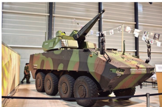
Figura 8: Skyranger 30 integrado ao chassi Mowag Piranha 8x8 Fonte: (Rieder, 2023)
